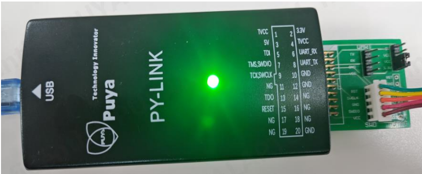
图 1-2. PYLink CON20 引脚图
